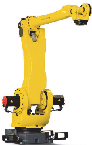
2 pav. Paletavimo robotas FANUC M-410iB/140H
