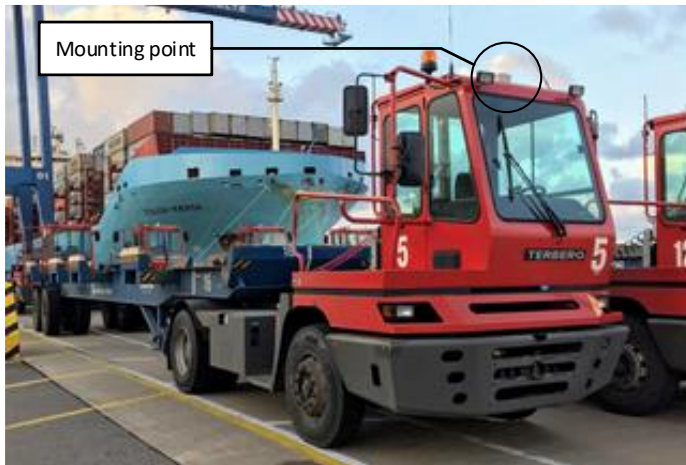
11 pav. Naudotų vilkikų ir eksperimentui pasirinktos įrangos tvirtinimo vietos vaizdavimas
