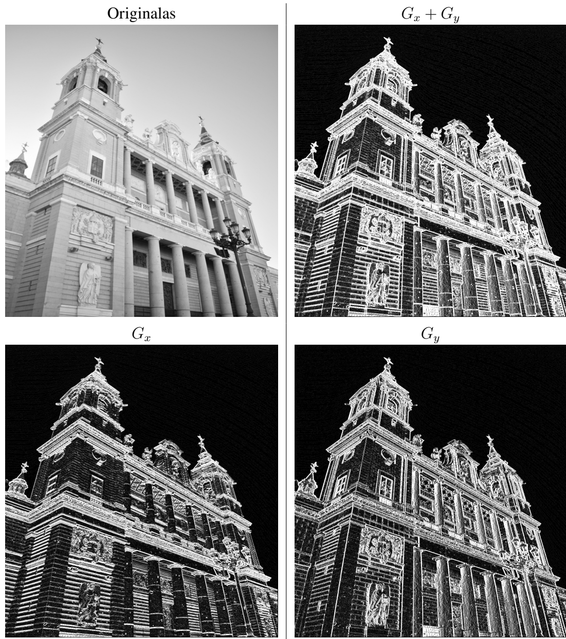
2 pav. G_x ir G_y gradientų palyginimas su originalia nuotrauka (nespalvota) ir po pilno „Schar“ algoritmo pritaikymo. Nuotrauka nr. 1.
