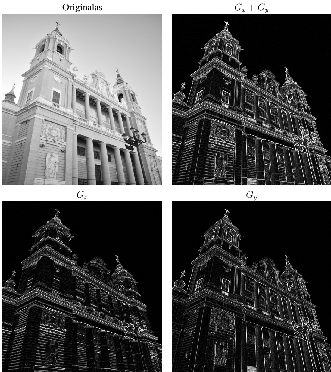
1 pav. G_x ir G_y gradientų palyginimas su originalia nuotrauka (nespalvota) ir po pilno „Sobel“ algoritmo pritaikymo. Nuotrauka nr. 1.
