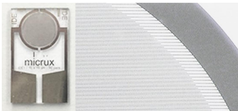
10 pav. Kairėje Micrux ED-IDE3-Pt šukos, dešinėje padidintas jų vaizdas.
