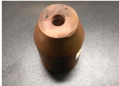
17 pav. Purkštukas naudojamas oro srauto nuo apatinės pusės nukreipimui. Purkštuko išėjimo diameteras – 3 mm, o atstumas nuo purkštuko iki stiklo plokštelės – 3 mm
