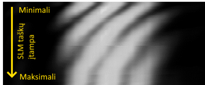
15 pav. SLM fazės vėlinimo kalibravimo paveikslas, kuriame matomas nedidelis netiesiškumas ir stiprus fazės mirgėjimas poveikis prie maksimalios įtampos.
