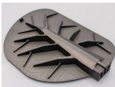
9 pav.: Galvanoskenerio veidrodžio pagaminto iš SiC galinė pusė [28].
