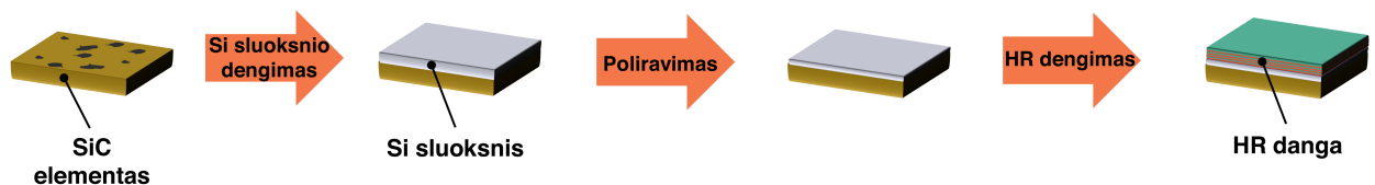
27 pav.: SiC elemento atspindžio padidinimo UV srityje (355 bangos ilgis) struktūrinė schema.
