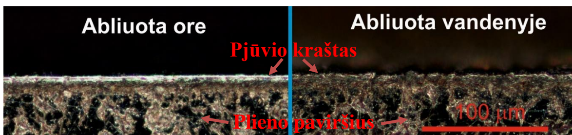
22 Pav. Pliene išpjauto kanalo optinės nuotraukos, kai abliuota ore (kairėje) ir pro vandens sluoksnį (dešinėje).
