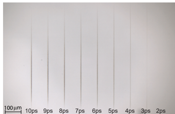
21 pav. Radialinės poliarizacijos vektorinio Beselio-Gauso pluošto komponente padaryti pažeidimai lydyto kvarco stikle esant fiksuotai 67.5 \mu\text{J} impulso energijai ir skirtingoms impulso trukmėms.
