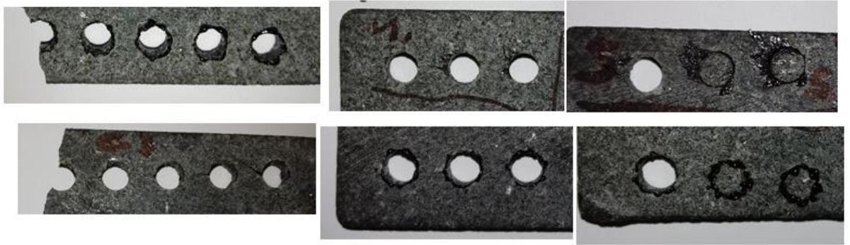
31 pav. 3,5 mm storio Indiško juodo granito plokštelės pjovimas keičiant pjovimo greitį. Iš kairės skylės išpjautos 2; 3; 5; 7; 10; 15; 20; 25; 30; 35; 40 mm/s pjovimo greičiai.
