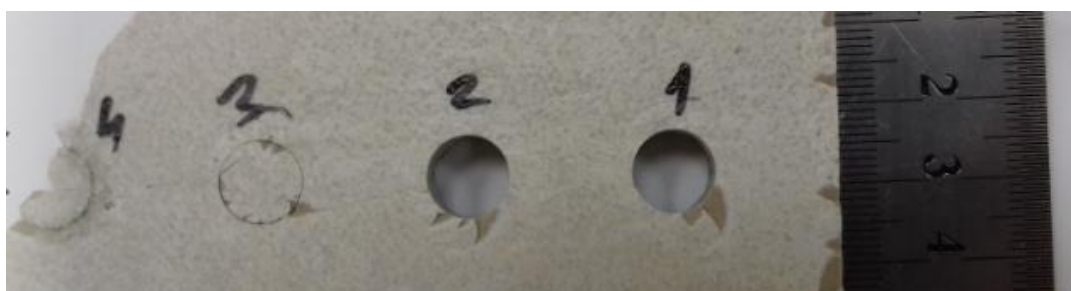
22 pav. Akmens masės plytelė pjauta naudojant 300 W nuolatinės veikos šviesolaidinį lazerį. Naudoti pjovimo greičiai: 1 skylė (iš dešinės) - 1,5 mm/s; 2 skylė - 2 mm/s; 3 skylė - 4 mm/s; 4 skylė - 6 mm/s, pjovimą pakartojant 2 kartus.
