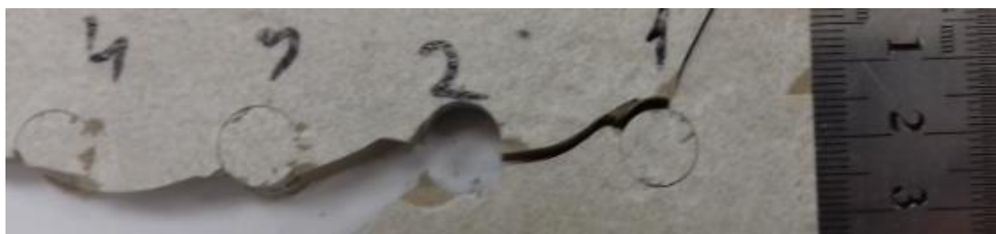
24 pav. Akmens masės plytelė pjauta naudojant 400 W nuolatinės veikos šviesolaidinį lazerį. Naudoti pjovimo greičiai: 1 skylė (iš dešinės) - 1,5 mm/s; 2 skylė - 2 mm/s; 3 skylė - 4 mm/s greitis; 4 skylė - 6 mm/s, pjovimą pakartojant 3 kartus.
