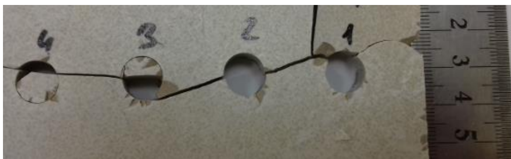
20 pav. Akmens masės plytelė pjauta naudojant 400 W nuolatinės veikos šviesolaidinį lazerį. Naudoti pjovimo greičiai: 1 skylė (iš dešinės) - 1,5 mm/s; 2 skylė - 2 mm/s; 3 skylė - 4 mm/s; 4 skylė - 6 mm/s; pjovimą pakartojant 2 kartus.
