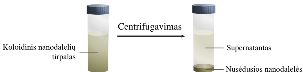
9 pav. Koloidinis nanodalelių tirpalas prieš ir po centrifugavimo.
