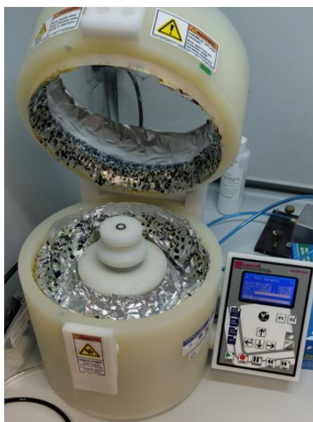
11 pav. Sluoksnių formavimui liejimo ant besisukančio padėklo būdu skirtas prietaisas Laurell .
