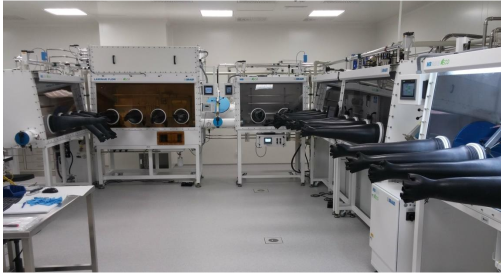
15 pav. Inertinės atmosferos spintos esančios Fotonikos ir nanotechnologijų instituto Organinės optoelektronikos grupės laboratorijoje ISO 7 klasės švariose patalpose.
