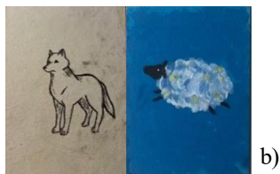
1 pav. Eksperimento metu naudotas bandinys. a) Pirmo sluoksnio grafito pieštuku pieštas vilko atvaizdas. b) Antro sluoksnio akrilinais dažais pieštas avies atvaizdas
