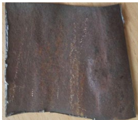
16 pav. Rūgštinės korozijos, dažniausiai – sieros rūgšties H_2SO_4 , palikti koroziniai požymiai. Paviršius lygus, be aiškių metalo storio pokyčių. Dešinėje pusėje – elektroniniu mikroskopu darytos paviršiaus nuotraukos, mastelis – 80 mkm
