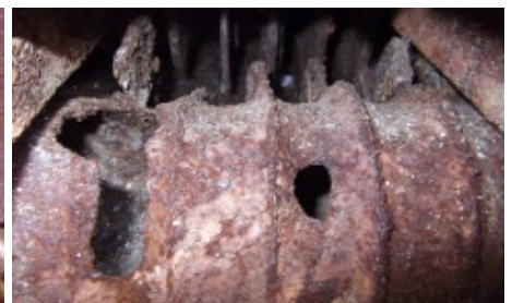
13 pav. Biokuro vandens šildymo katilo ekonomaizerio iš ketaus vamzdžių korozija
