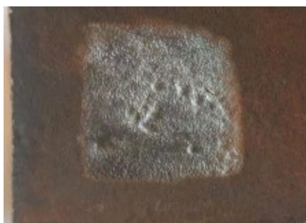
18 pav. Mišrios – rūgšties ir chloro druskų korozijos paveikto metalo vaizdas. Dešinėje pusėje – elektroniniu mikroskopu darytos paviršiaus nuotraukos, mastelis – 500\text{ mkm}
