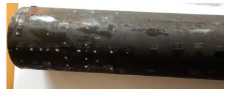
6 pav. Vamzdžio sienelės storio matavimo taškų išdėstymas
