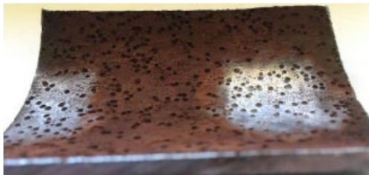
17 pav. Chloro druskų palikti korozijos pėdsakai. Aiškiai matomi druskų pažeistos vietos, korozija pasižymi taškiniu poveikiu. Dešinėje pusėje – elektroniniu mikroskopu darytos paviršiaus nuotraukos, mastelis – 300\text{ mkm}
