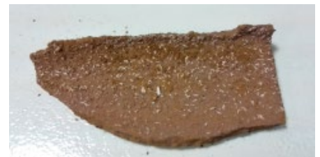
11 pav. Dumblo po kondensacinio ekonomaizerio pavyzdys. Spalva rodo vykstančią koroziją katile. Balti intarpai – sieros junginių sankaupos
