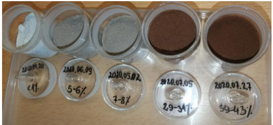
14 pav. Multiciklono pelenų spalva, priklausomai nuo geležies kiekio sudėtyje. Geležies kiekis pelenuose užrašytas skaičiais. Kairėje – balti pelenai, korozijos nėra, geležies kiekis pelenuose – mažiau 1 proc., o tai yra natūralu pelenuose be korozijos pėdsakų. Geležies kiekis 5–8 proc. indikuoja, kad katilė jau vyksta korozija, tačiau ji dar nėra labai intensyvi, pelenų spalva vizualiai išlieka pilka. Geležies kiekis 20 proc. ir daugiau rodo vykstant intensyvią koroziją
