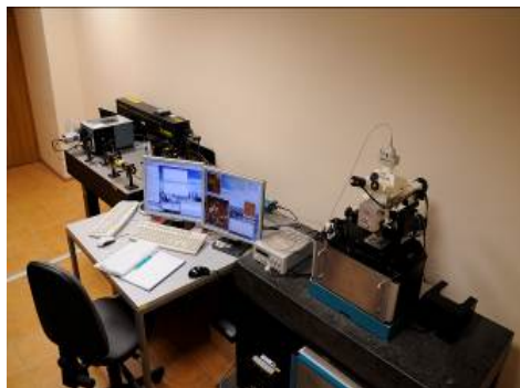
2.4.2 pav. Konfokalinis mikroskopas Witec Alpha 300 S su spektrometru [83].
