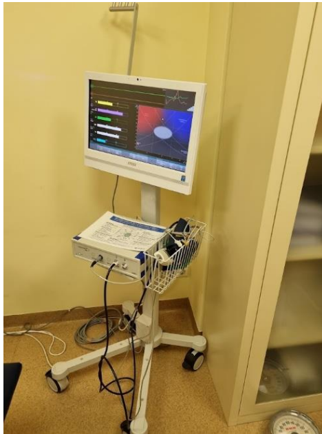
8 pav. Krūtinės ląstos varžos matavimo prietaisas CardioScreen 2000 (Medizinische Messtechnik GmbH, Vokietija).
