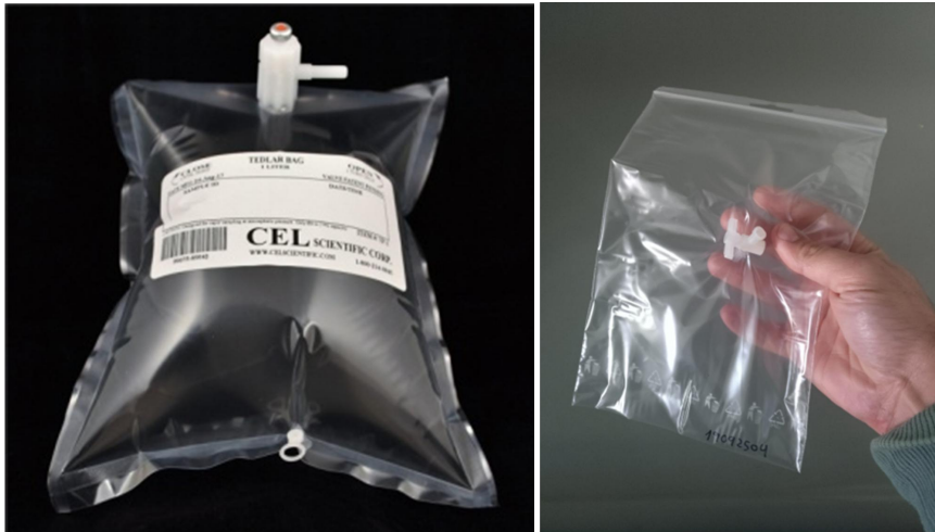
Pav. 5: Tedlar® maišelis (kairėje) ir sukurta Minigrip LDPE plastikinių maišelių surinkimo sistema (dešinėje).
