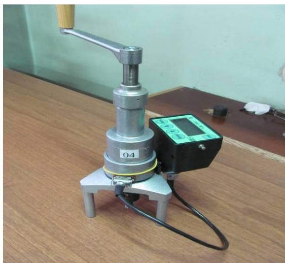
Рисунок 2.2. – Прибор PCSO-2,5MG4 для измерения прочности адгезионного соединения
