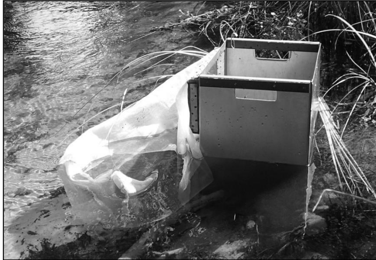
6 pav. Vingilių gaudymui naudotas Surber tipo bentosinis semtuvas, modifikuotas pagal Lasne et al. (2010b)
