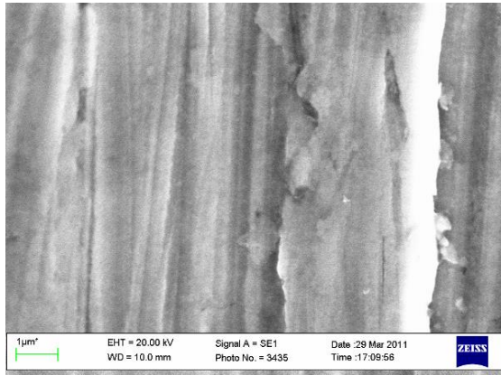
61 pav. 3% SiO 2 (su NH 3 ) padengto ir modifikuoto su 10% HMDS vario paviršiaus SEM nuotrauka
