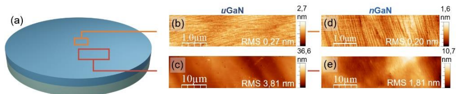
Pav. 8 GaN/safyras ruošinio struktūra (a). AFM topografiniai vaizdai atliekant skirtingų plotų skenavimus: nelegiruoto GaN paviršius (b) ir (c) bei Si legiruoto GaN paviršius (d) ir (e).
