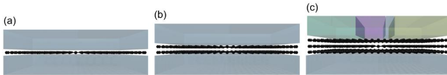
Pav. 7 GaN auginimas ant monosluoksniu, dvisluoksniu ir trisluoksniu grafenu padengtų GaN padėklų. Skirtingos spalvos iliustruoja skirtingos orientacijos GaN.
