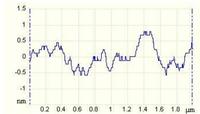
Pav.5.3. Plonojo EBC sluoksnio paviršiaus morfologija. AFM dvimatis vaizdas (kairėje) ir paviršiaus pjūvio Z ašies kryptimi vaizdas (dešinėje). Šiurkštumas: vid. – 0,29 nm, max – 2,94 nm.
