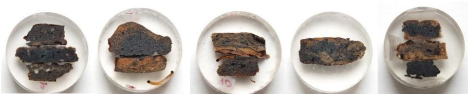
4 pav. Epoksidinės dervos blokuose įmontuoti šlifuoti šukių vertikalūs pjūviai.
