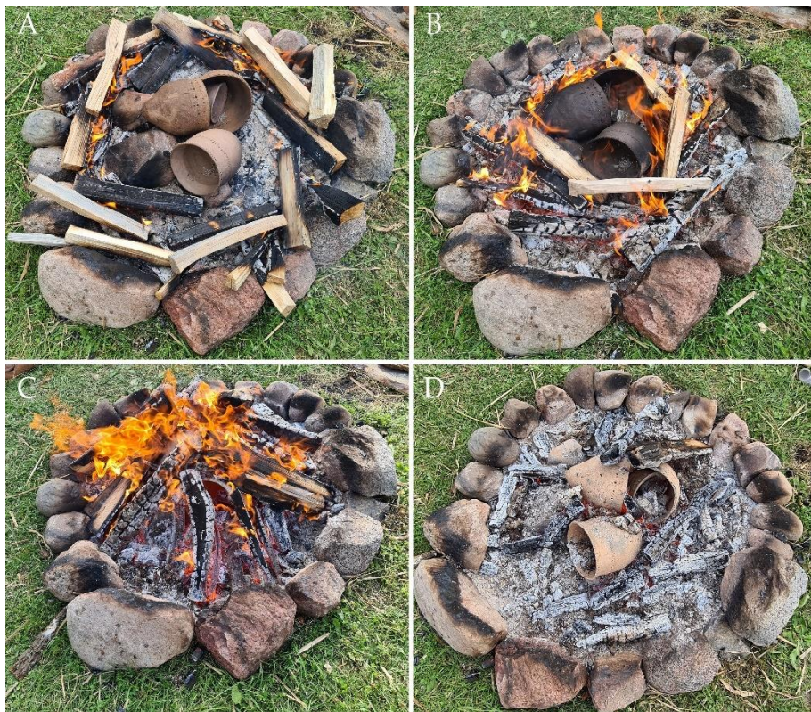
104 pav. Keramikos išdegimo atviraime lauže etapai: A – šildymas; B – keramika po truputį apkraunama malkomis; C – degimas; D – atvėsinimas lauže (VšĮ „Vilniaus puodžių cechas“ kūriny).
