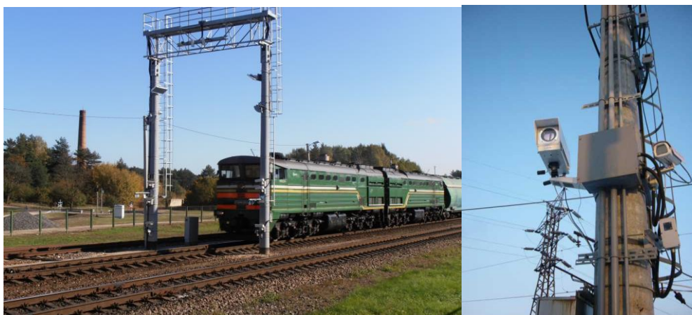
13 pav. AKAS automatizuota traukinių ir vagonų komercinės apžiūros sistema
