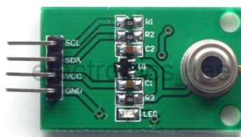
3.9 pav. MLX90614 IR spindulių temperatūros daviklis[29]
