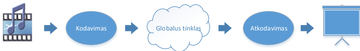
Pav. 1. Srautinio vaizdo siuntimo kodavimas – atkodavimas
