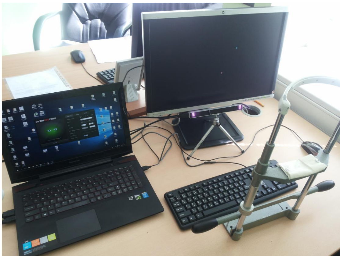
14 pav. Akių judesių registravimo sistemos schema
