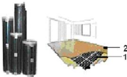
1.8 pav. Šildymo kabelio kilimėlis: 1 – grindys; 2 – kabelio kilimėlis
