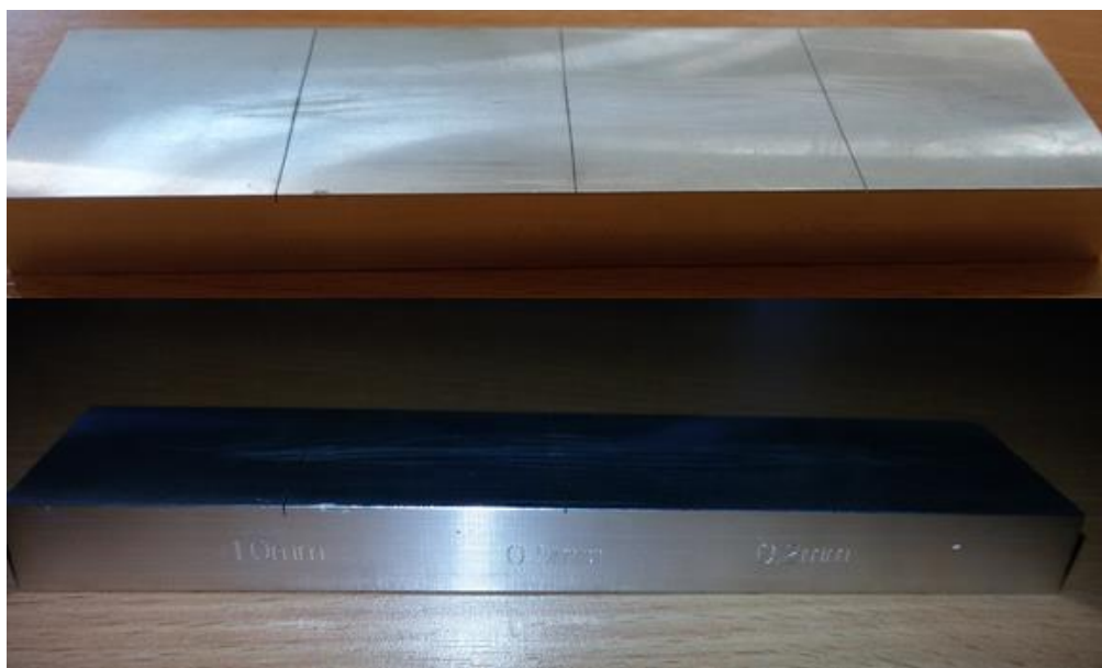
3.5 pav. Sūkurinių srovių kalibravimo blokas
