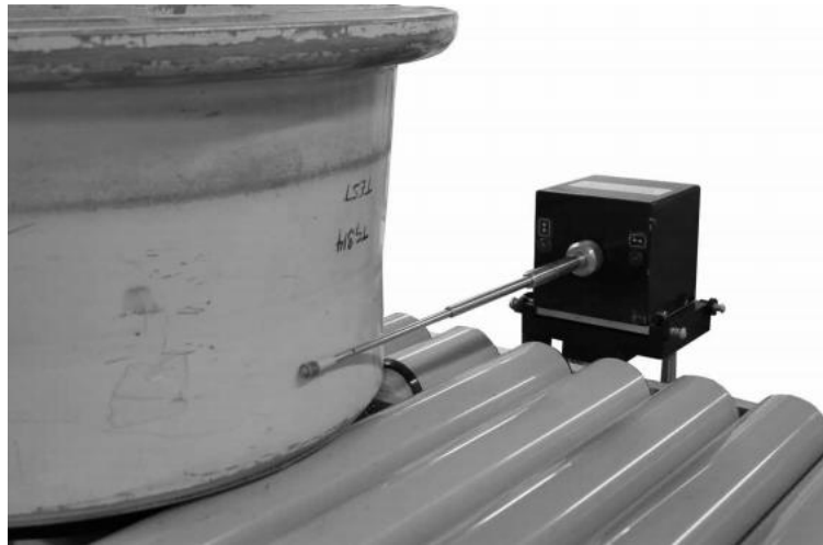
2.13 pav. Wheelscan stalas su bėgeliais
