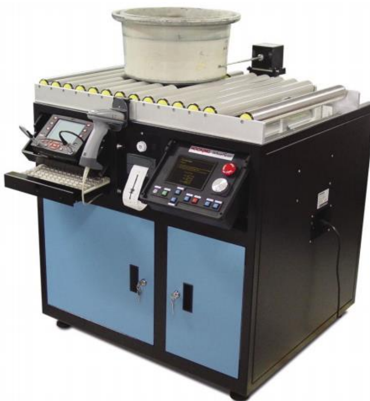
2.12 pav. Automatizuota „WheelScan 5“ sūkurinių srovių sistema
