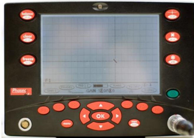
2.11 pav. Sūkurinių srovių prietaisas „Phasec 2D“
