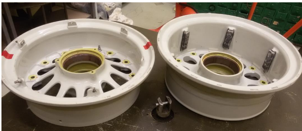
3.7 pav. Rato stebulės išorinė ir vidinė pusės
