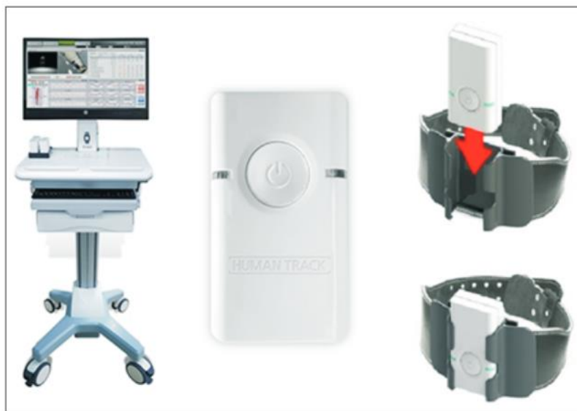
2 pav. Cho ir kitų tyrime naudojami inerciniai judesių matavimo vienetai.
