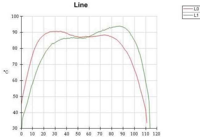
14 pav. Plokštės BANDINYS A temperatūrų kreivės linijose L0 ir L1 po 40 min. nuo įjungimo pradžios
