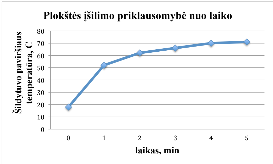
75 pav. BANDINYS X šildymo plokštės įšilimo temperatūros priklausomybė nuo laiko.
