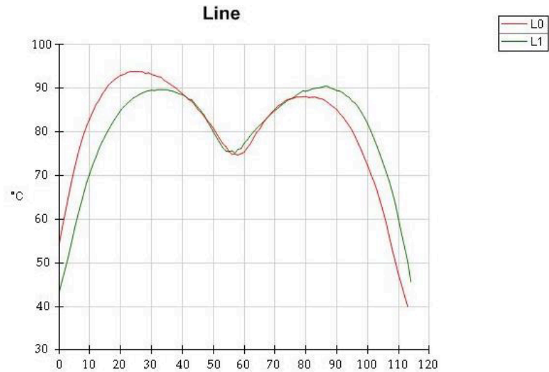
20 pav. Plokštės BANDINYS B temperatūrų kreivės linijose L0 ir L1 po 46 min. nuo įjungimo pradžios
