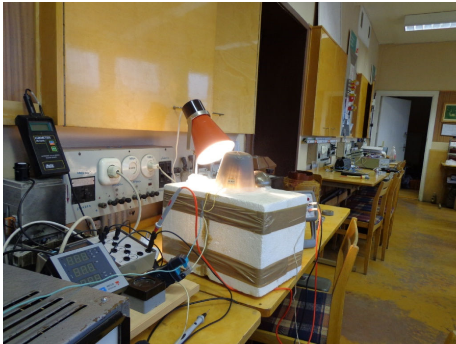
3.17 pav. Šiluminių nuostolių tyrimo stendas
