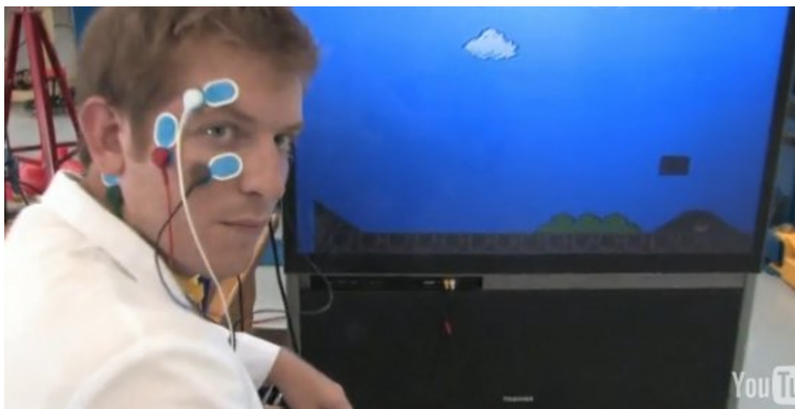
3.5 pav. Akies sekimas elektrodais pritvirtintais aplink akį.
