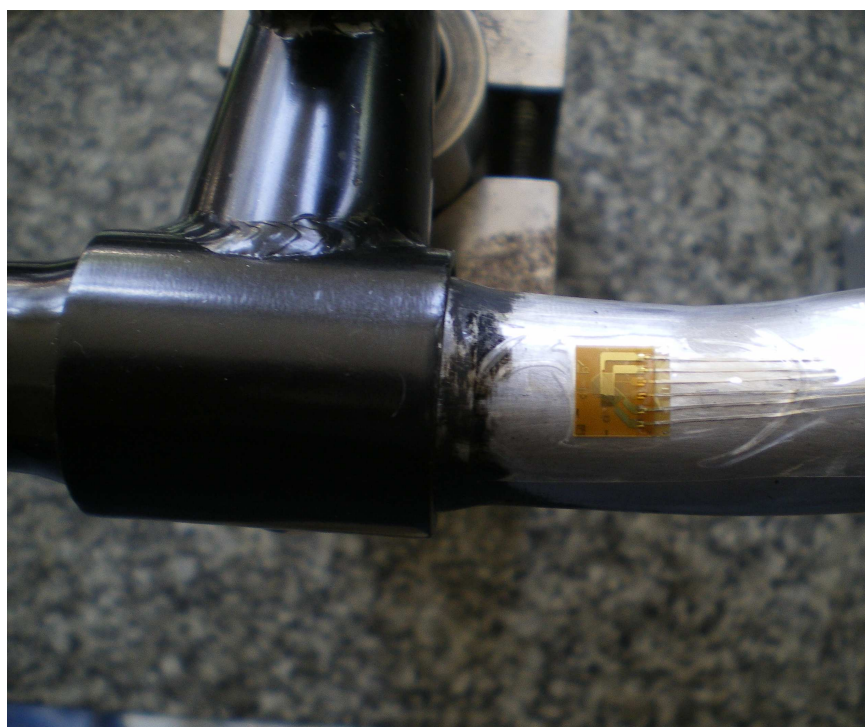
3.4 pav. Tenzorezistoriaus rozetės klijavimas
