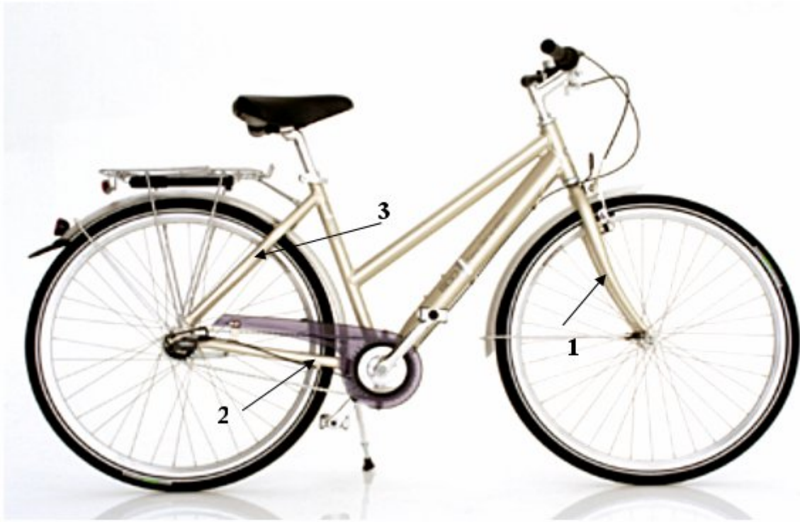
3.4 pav. Jutiklių išdėstymo schema: 1 – pirmųjų jutiklių vieta; 2 – antrųjų jutiklių vieta; 3 – trečiųjų jutiklių vieta
