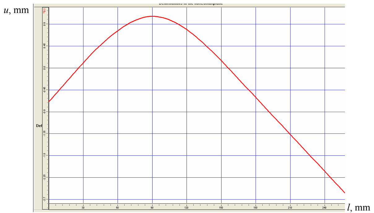
4.13 pav. Veleno deformacijų horizontalioje plokštumoje diagrama
