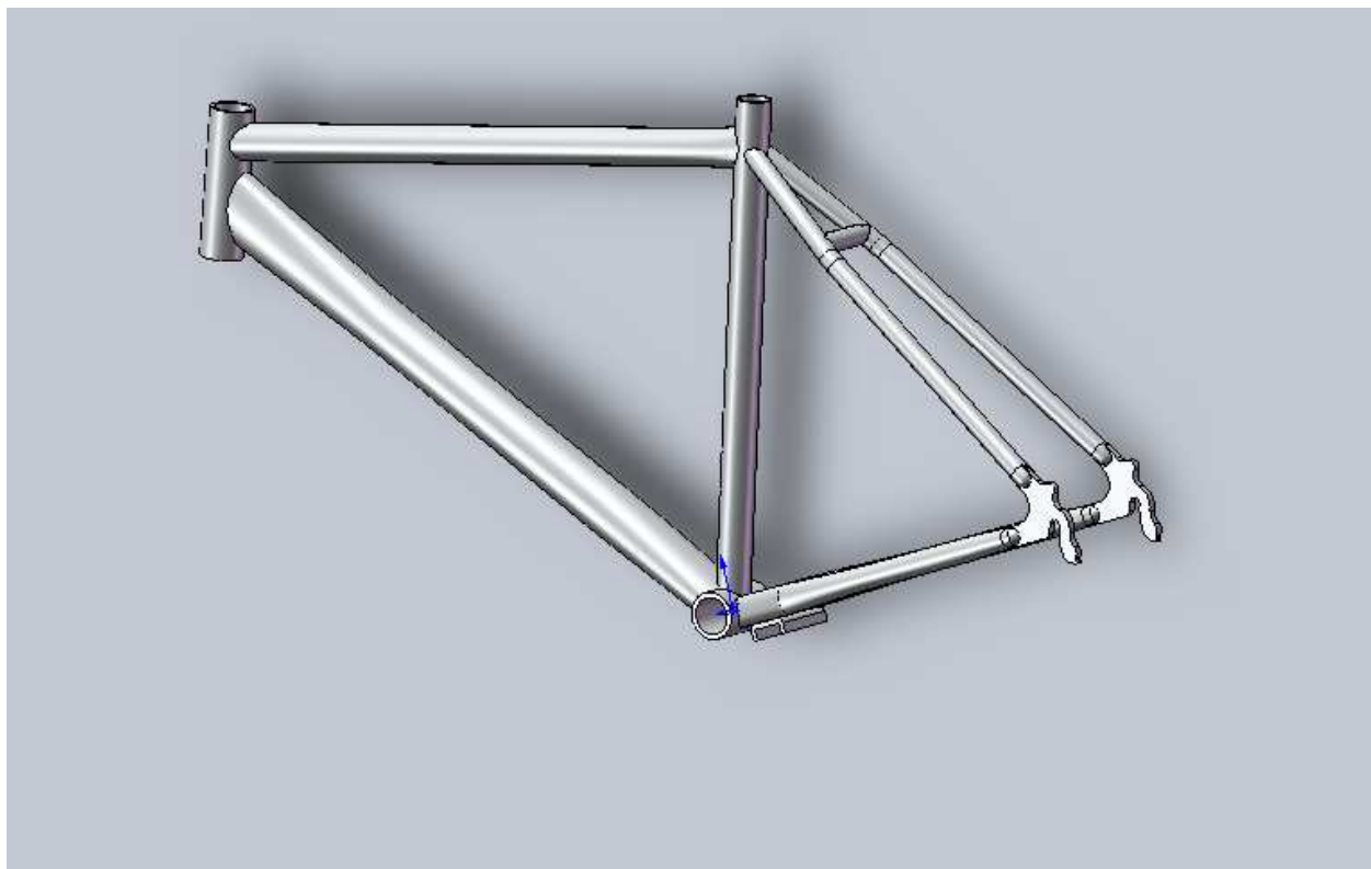
3.8 pav. Nagrinėjamo rėmo modelio vaizdas
