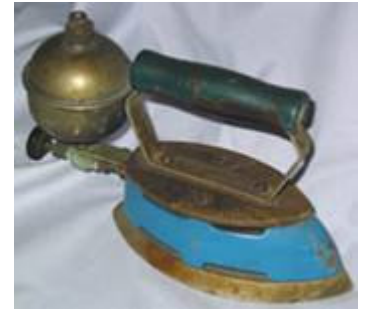
49, 50, 51 pav. Lygintuvai kaitinami degiu skysčių (su talpa skysčiui ir pompa).
