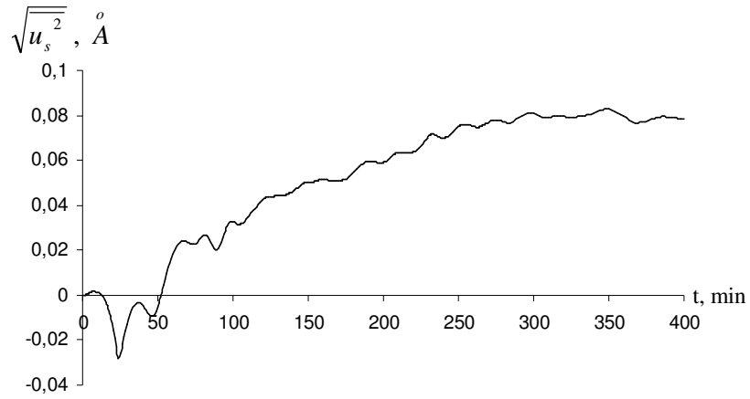
36 pav. Pirmojo kvarco bandinio gardelės vidutinių kvadratinių nuokrypų pokytis, dėl rentgeno spinduliuote švitinimo eigoje generuotų taškinių defektų, kai U_a = 20kV , I_a = 20mA ir t = 20^\circ C
