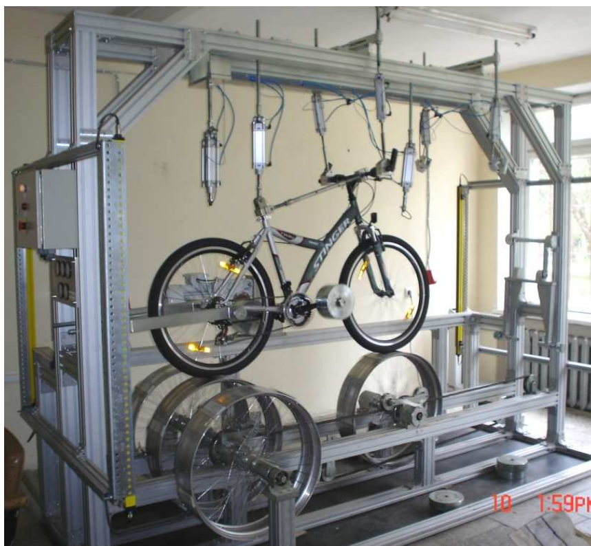
1.2 pav. Struktūrinio vientisumo bandymo stendo vaizdas
