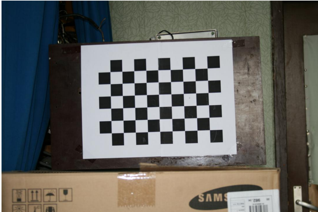
5.1 pav. Kalibravimo šablonas: šachmatų lenta.
