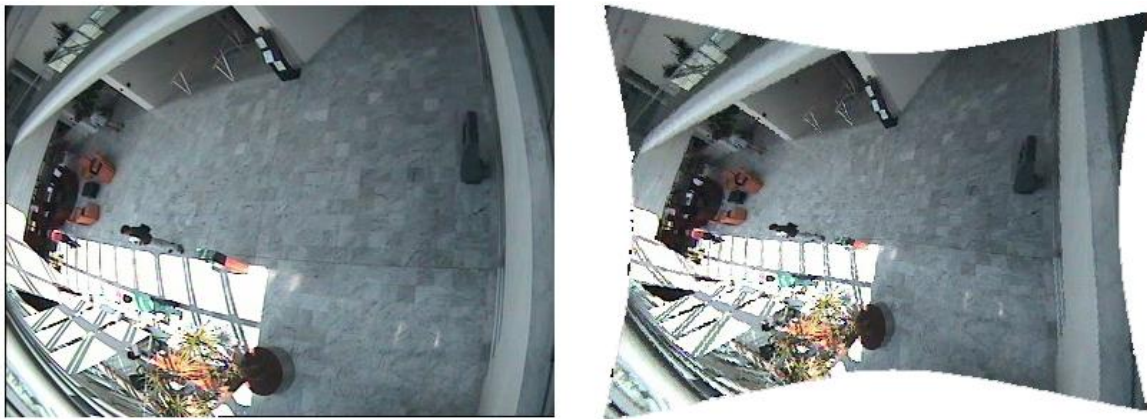
1.3 pav. Iškraipytas vaizdas (kairėje), ištaisytas nuo iškraipymų vaizdas (dešinėje)
