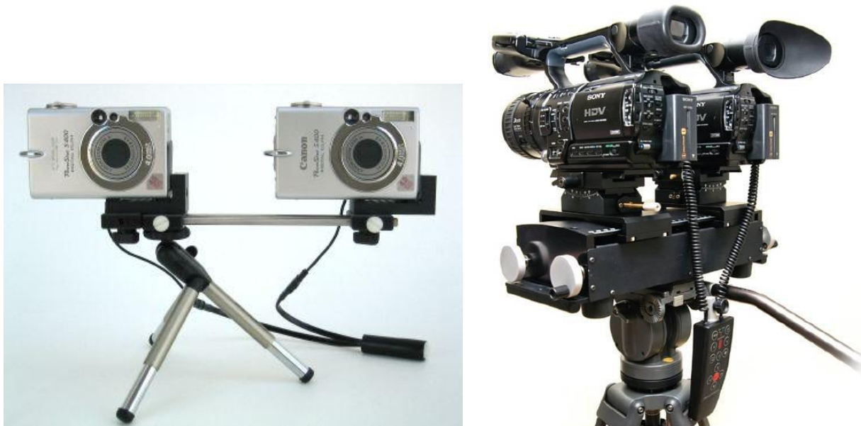
1.1 pav. Vartotojiškos stereovaizdo kameros Canon PowerShot S400 (kairėje) ir pramoninės gamybos stereovaizdo kameros Sony HDV (dešinėje), kurių vaizdo jutikliai yra vienoje plokštumoje bei optinės ašys lygiagrečios
