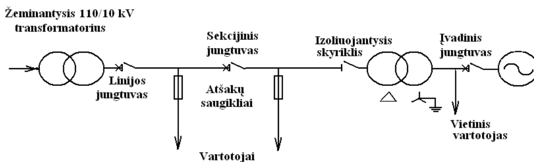
9 pav. Vėjo elektrinės prijungimas skirstomojo tinklo maitinančiosios linijos gale[9].
