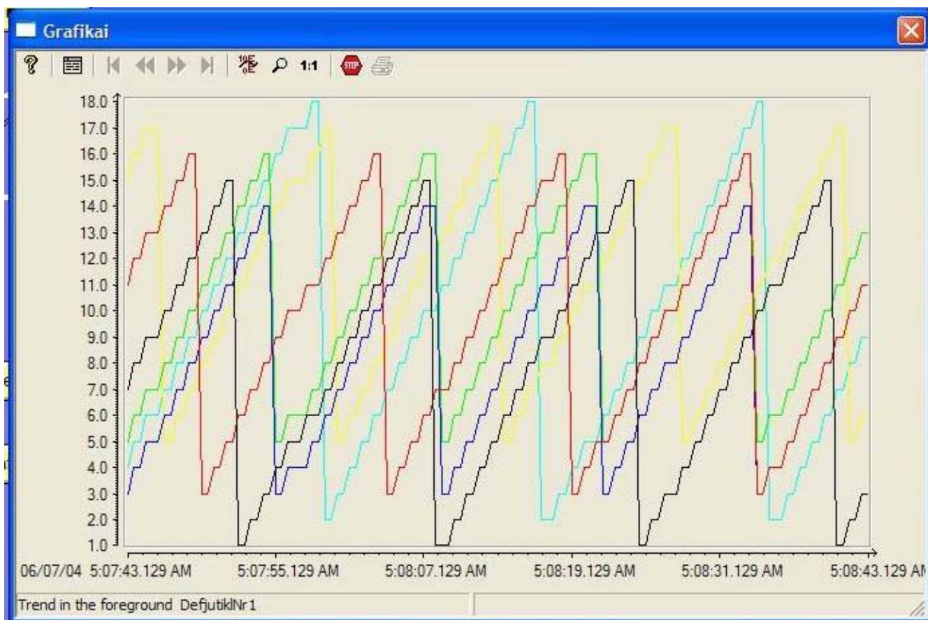
7.8 pav. Grafikų brėžimas panaudojant valdymo funkciją „WinCC Online Trend control“
