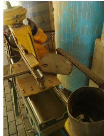
2.1 pav. Mašininės rankinės kotų galų konusavimo staklės
