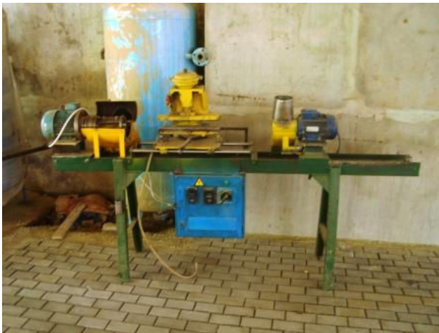
2.1 pav. Mašininės rankinės kotų galų konusavimo staklės
