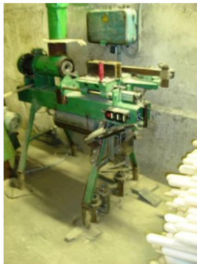
2.3 pav. Pusiau automatinės kotų galų konusavimo staklės
