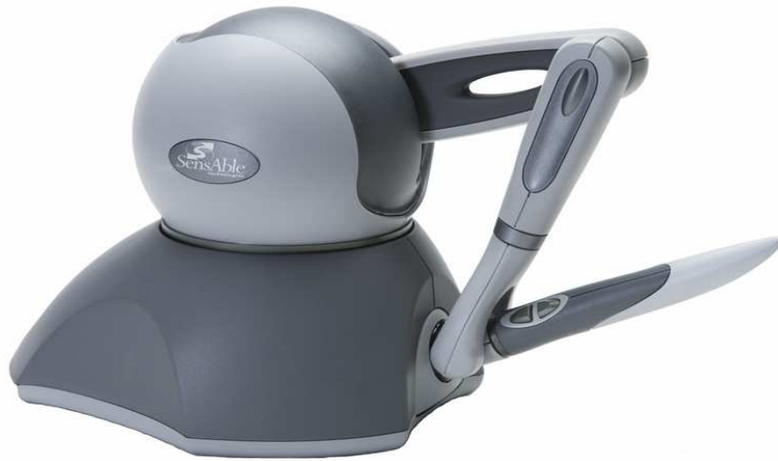
2.1.2.1 pav. Jėgos grįžtamojo ryšio prietaisas „Phantom omni“ [7]
