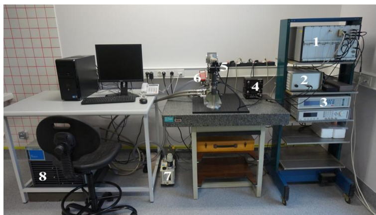
2.20 pav. HERA DLTS System 1030 spektrometro schema C-DLTS matavimams ir bendras spektrometro vaizdas. I-DLTS matavimams atjungiamas Boonton matuoklis. 1-pagrindinis DLTS modulis, 2-talpinis tiltas, 3-temperatūros stabilizavimo valdiklis, 4-lazerio valdiklis, 5-lazerio spinduolis, 6-uždaro ciklo helio kriostatas, 7-vakuuminis siurblys, 8-kompresorius.
