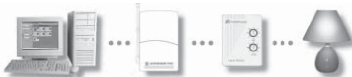
6.1 pav. X-10 standartinė instaliacija
