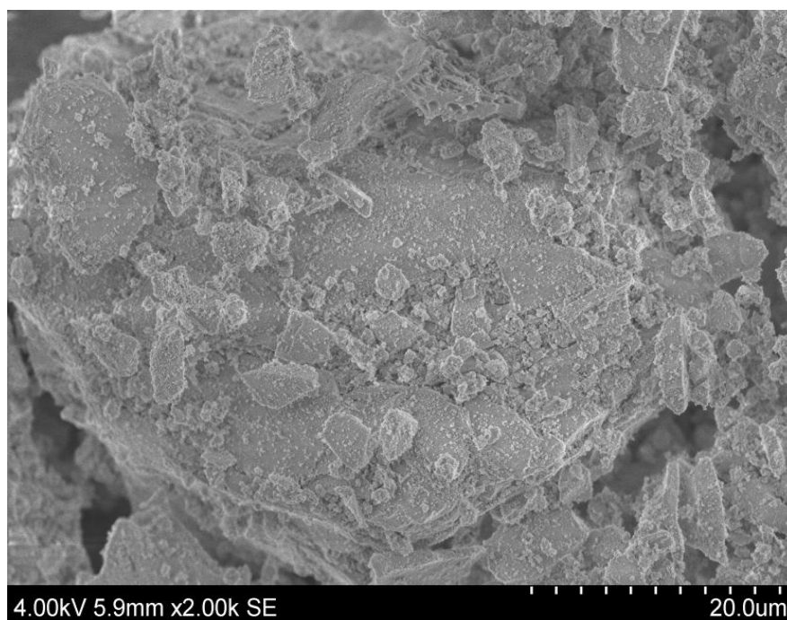
23 pav. \text{Ho}_3\text{Al}_5\text{O}_{12} , gauto zolių-gelių metodu 1000 °C temperatūroje, SEM nuotrauka.
