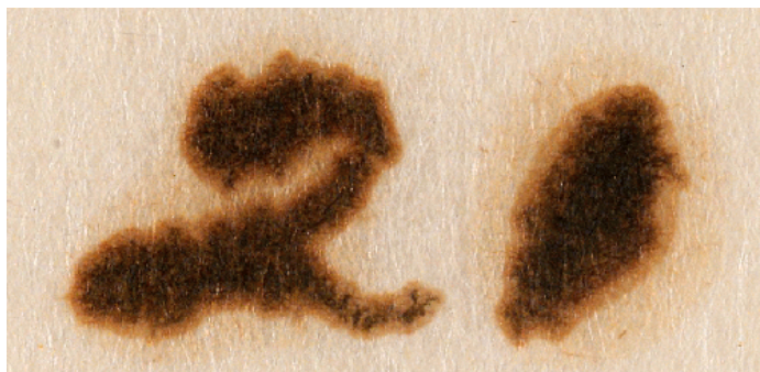
11 pav. Dėl sieros rūgšties migravimo aplink rašmenis susidarę ratilai – šalia rašalu padengtų sričių pasikeitusi popieriaus spalva [62]
