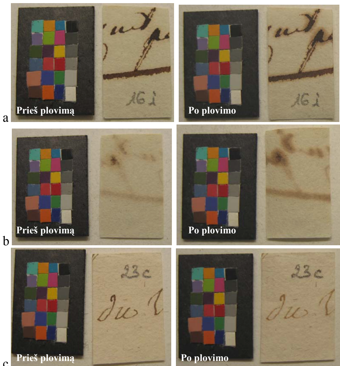
17 pav. Plovimo procedūrų metu vykstančių nepageidaujamų padarinių pavyzdžiai: a) horizontalus rašalo migravimas; b) transversalus rašalo migravimas; c) rašalo spalvos pokytis [146]
