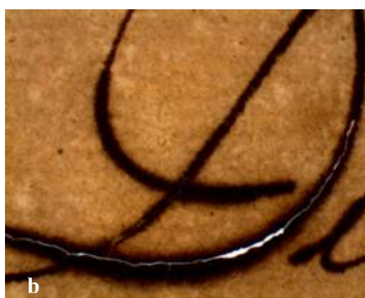
18 pav. Mechaninis pažeidimas, atsiradęs dėl nevienodo gretimų rankraščio sričių brinkimo: a) brinkimo schema; b) įskilimas istorinio rankraščio fragmente [147]
