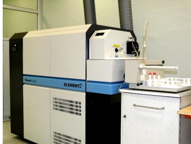
6 pav. Indukcinės plazmos masių spektrometras Element2 ir (dešinėje) skystų bandinių įvedimo sistema.
